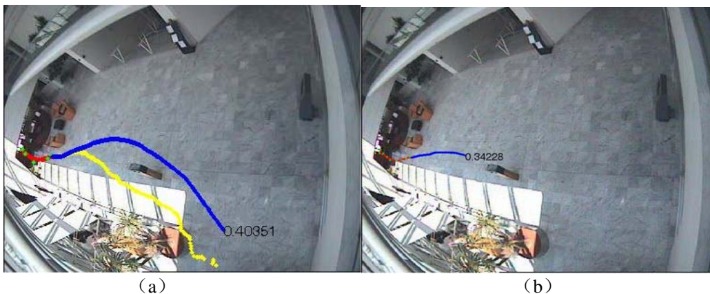
图 4-14 基于 DTW 对齐轨迹和按最短轨迹直接截取得到轨迹预测结果
