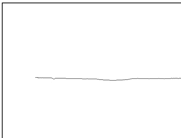
图 3-16 中值滤波和形态学处理后的激光线骨架。
