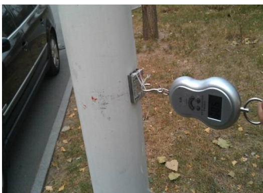
图 5-16 吸附单元吸附力测试。
