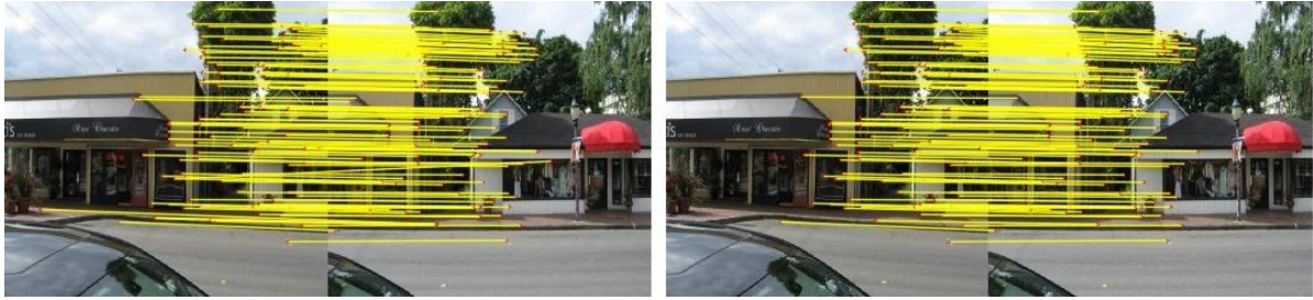
图 4.5 匹配结果图。左列是Lowe's算法得到的匹配图；右列是MKP算法得到的匹配图。
