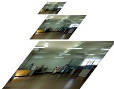
图 2-7 图像三层高斯金字塔示意
